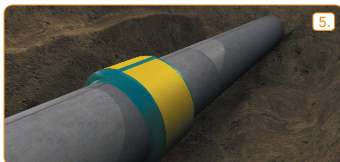
Aplikacja wypełniacza łagodzącego zmianę średnicy pomiędzy rurociągiem, a rękawem
